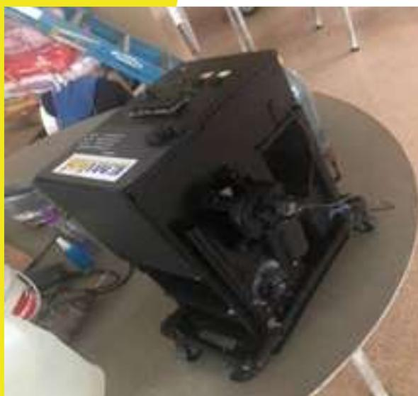
La función que cumple este fumígeno es desprender la concentración desinfectante a todos los rincones de un ambiente, por medio de la ascendencia y posteriormente la precipitación del humo.
